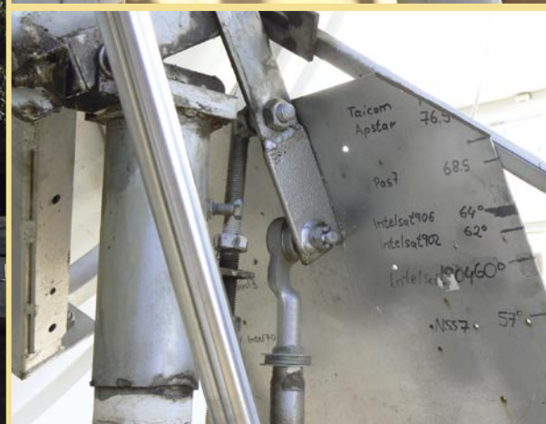
Feltétlenül lényeges dolog, amikor forgatjuk az antennát: egy fém műholdállás-beállító kalauz, mint amilyen itt látható a képen, számos helyzet-bejegyzéssel.
