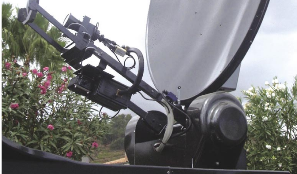
A 150 cm átmérőjű motoros tányérantenna, amely önműködően megnyílik a műholdra tájolóskor
