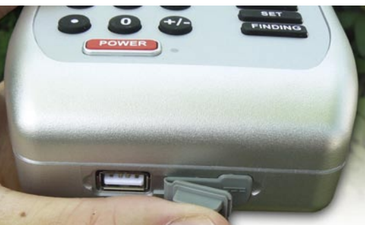
USB-kapu a számítógépes csatlakoztatáshoz, az áramellátó aljzat mellett.
