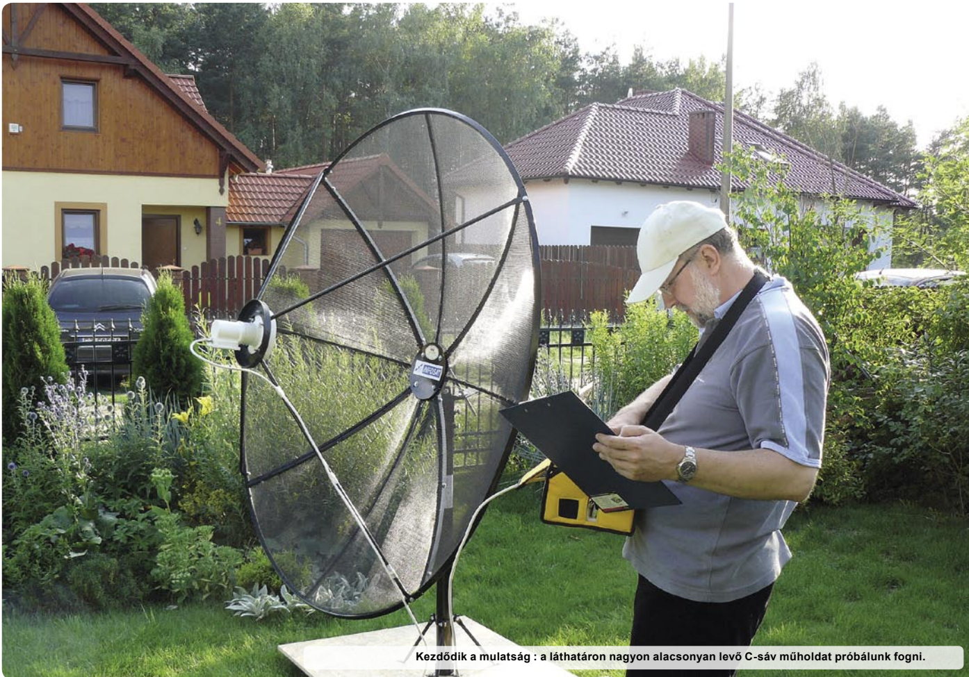
Útött az antenna betájolásának ideje. Szögmérővel ellátot vízszintmérő használatát ajánljuk, – hogy könnyebben beállíthassuk az elevációt.
