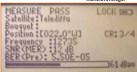
A nyugati hosszúság 22°-án levő NSS7-es műhold jelelemzése egy Invacom OptiScannal, és egy karimás optikai vevőfejjel!
