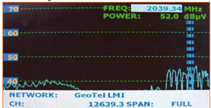
A keleti hosszúság 75°-án levő ABS1-es műhold szinképe a koaxiális műholdvevőfejjel!
