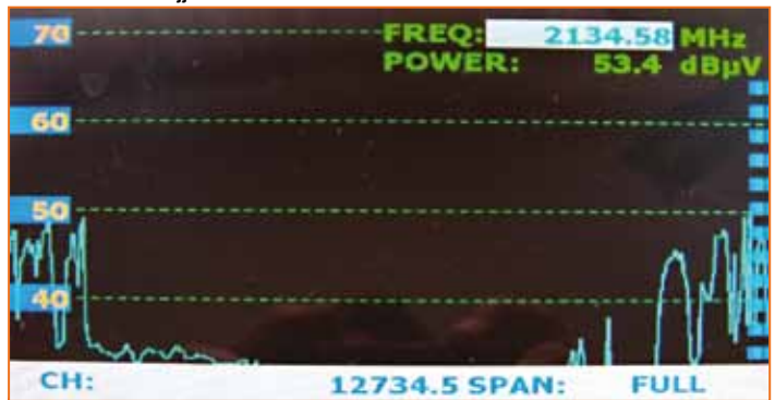
A nyugati hosszúság 22°-án levő NSS7-es műhold szinképe a koaxiális műholdvevőfejjel!
