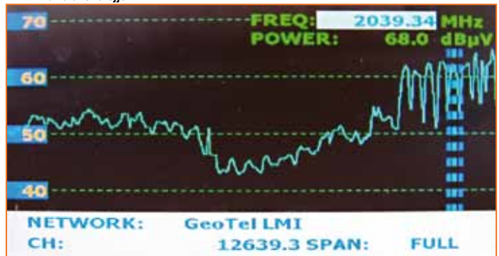
A keleti hosszúság 75°-án levő ABS1-es műhold szinképe az Invacom műholdvevőfejjel!
