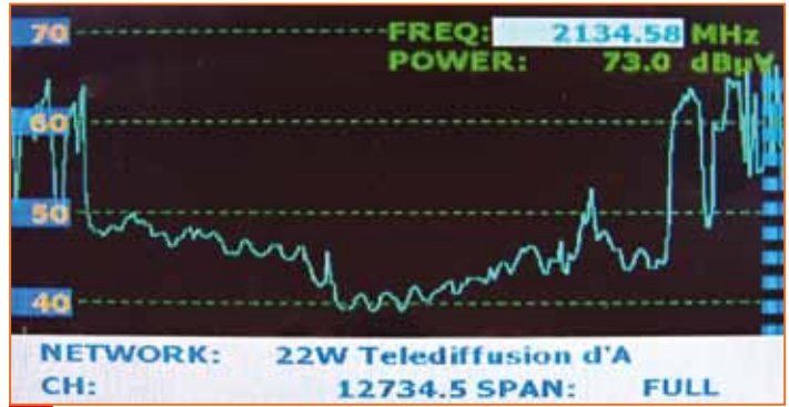
A nyugati hosszúság 22°-án levő NSS7-es műhold szinképe az Invacom műholdvevőfejjel!
