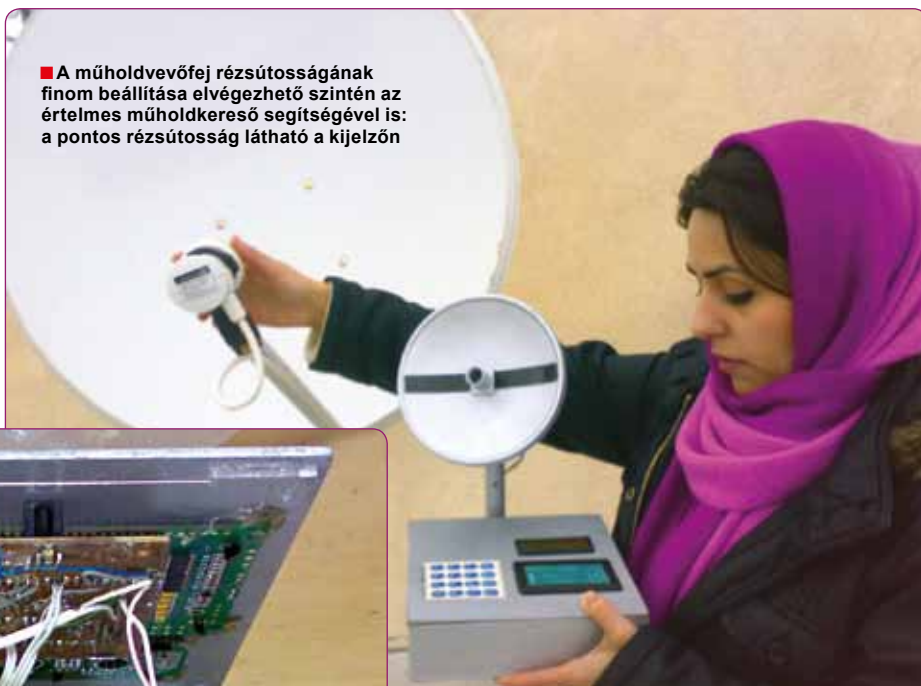
■ Így hogyan használják az értelmes műholdkeresőt: látható a fogható műholdak elhelyezkedése a nagy antenna pedig egyszerűen párhuzamos a kicsivel.
